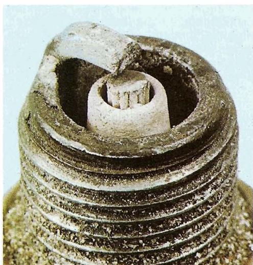
Un dépôt blanchâtre indique que le mélange détonant est trop pauvre. Nettoyez les bougies et vérifiez le réglage du carburateur.
