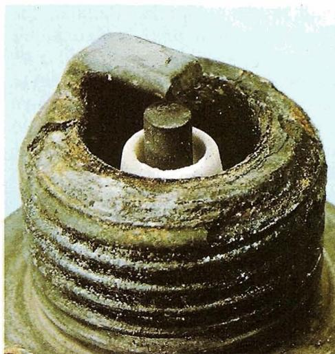
Une bougie mal vissée laisse s'échapper les gaz brûlés, ce qui endommage les filetages. Vérifiez le filetage de la culasse et remplacez la bougie.
