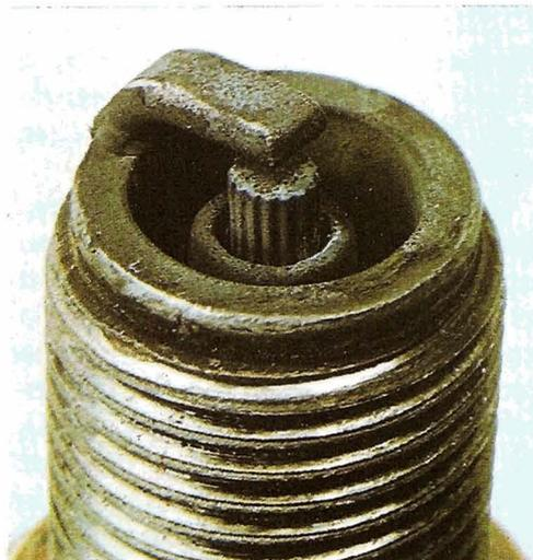
Un dépôt de suie indique que le mélange détonant air-essence est trop riche en carburant; il faut régler le carburateur.
