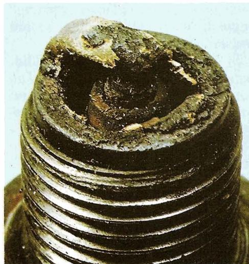
Une bougie laissée trop longtemps sans entretien finit par s'encrasser. Remplacez-la et procédez à des contrôles plus fréquents.
