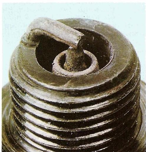
Si les électrodes ont été endommagées à cause d'une température excessive, assurez-vous que le degré thermique des bougies est convenable.
