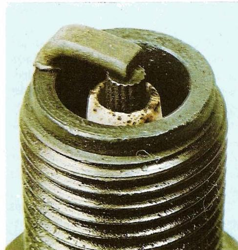
Un isolant constellé de taches indique que la bougie a été surchauffée; vérifiez que le degré thermique de la bougie est celui recommandé.
