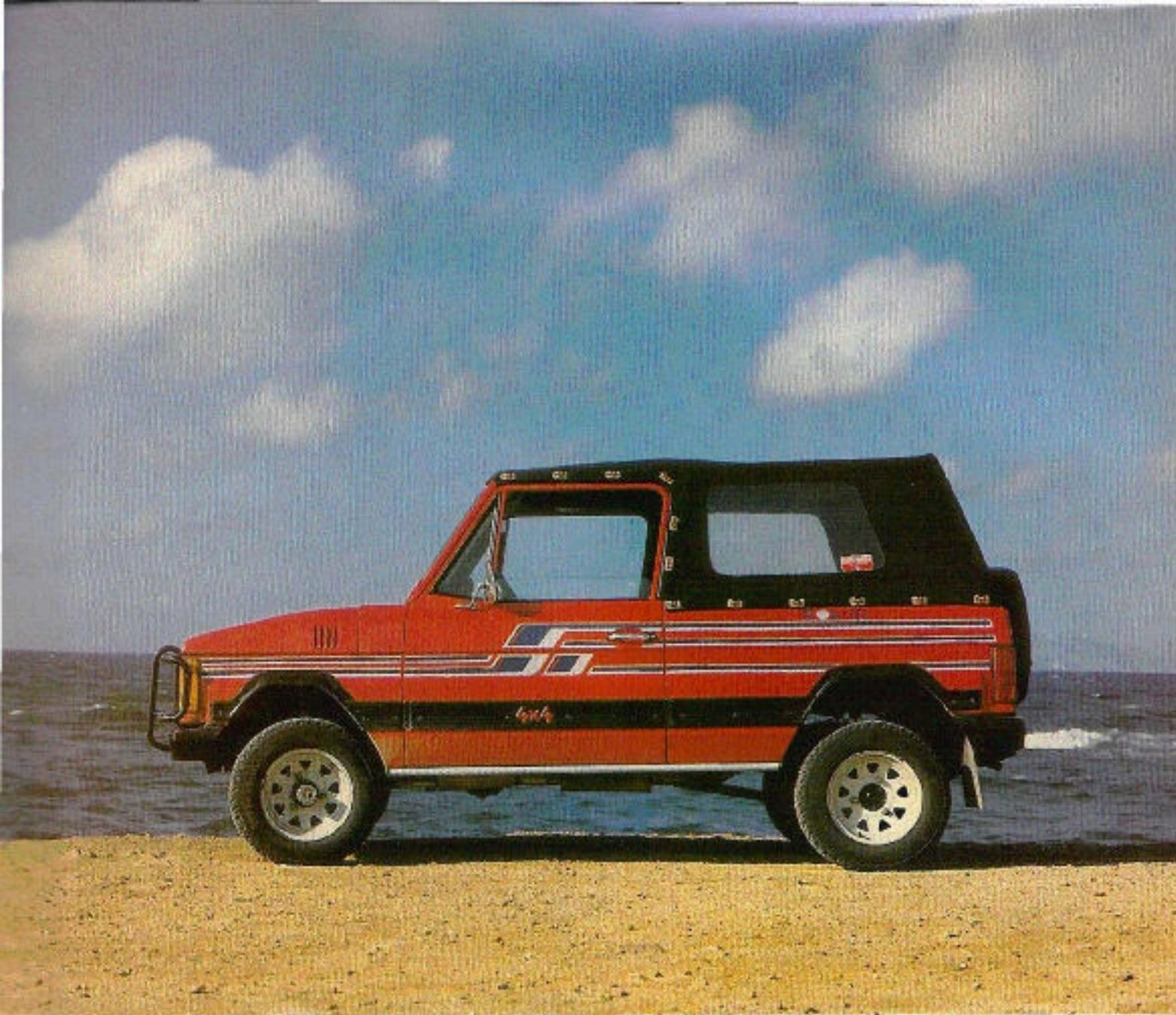
noter sous forte pluie quelques entrées d'eau du côté du masque avant, spécialement à droite. La capote baille le long des montants de porte et l'air s'y engouffre à haute vitesse, créant un tourbillon froid aux places arrière. A ce propos, le chauffage est puissant, mais le désembuage est très mal conçu et le ventilateur se signale par son bruit lancinant et son faible débit.
